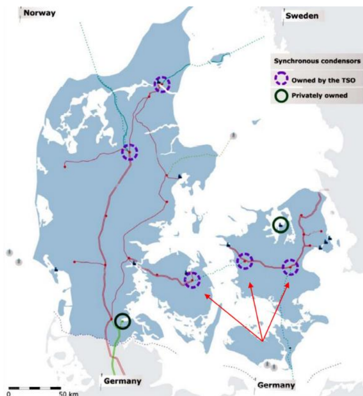
Figura 13: Distribución de los condensadores síncronos a lo largo de la red de transmisión de Dinamarca. Fuente: (IEA, 2021).
